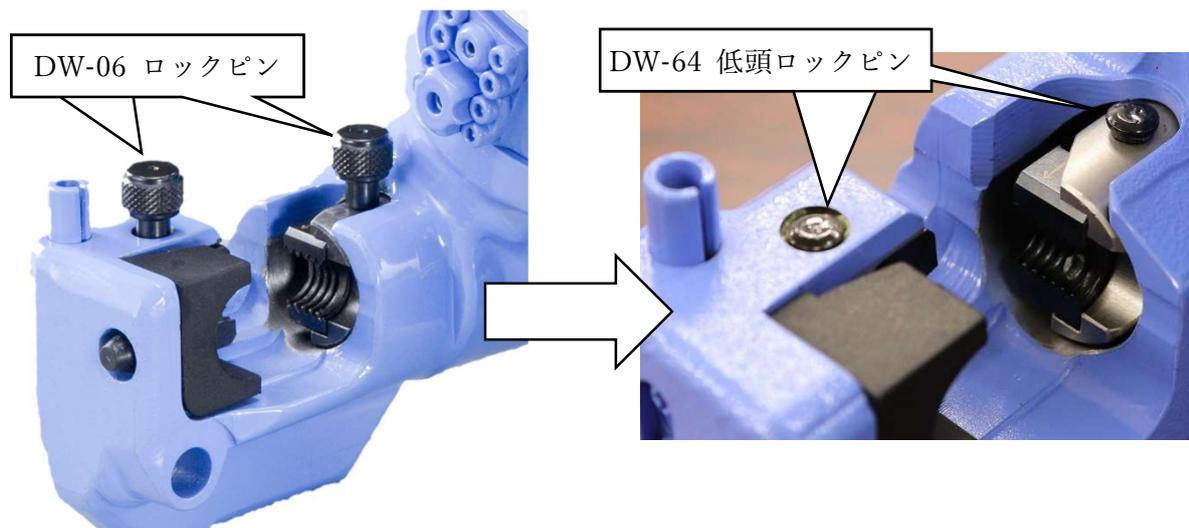
2. 上記 1.に伴い、下図のように取り外し時に工具が必要となるため本体にプラスドライバーを付属いたします。（ $\phi 4.5$  以下で長さ 50 以上の棒で代用可能です。）
